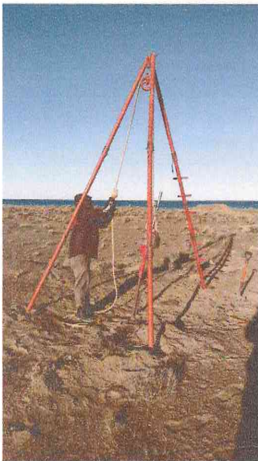
Ilustración 6: Ejecución del ensayo SPT
