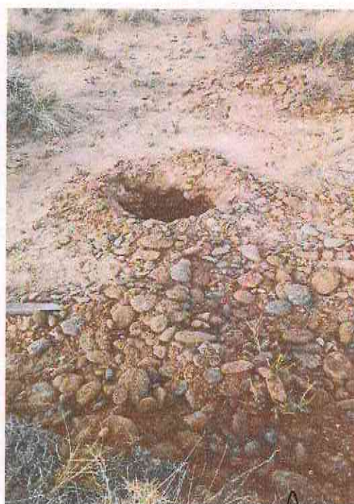
Ilustración 5: Muestra a -0,40m de profundidad obtenida de zona con evidencia de escurrimiento superficial de agua
