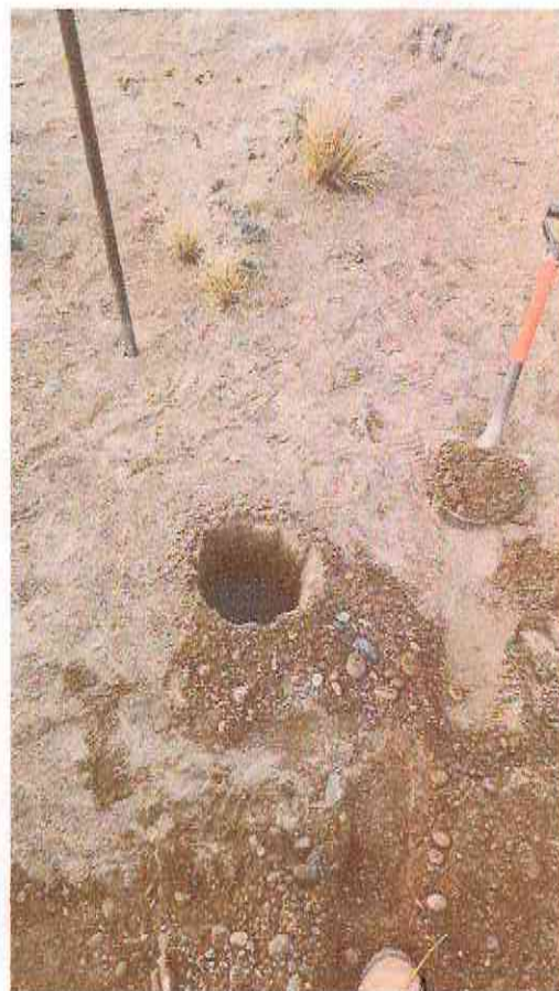
Ilustración 7: Sondeo con pala vizcachera
