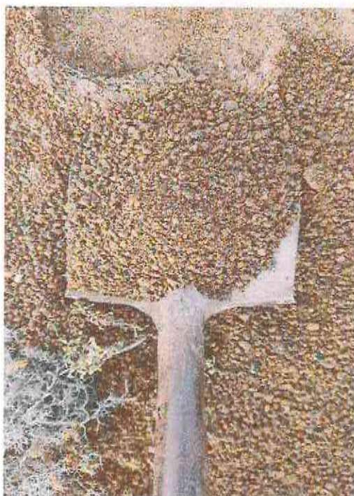
Ilustración 4: Muestra de suelo obtenida a -1,00m de profundidad.
